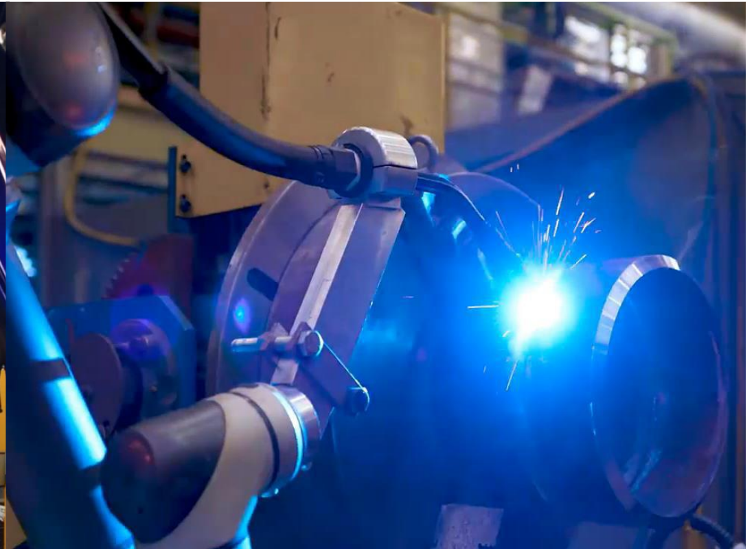
배관 용접 자동화(Rainbow Robotics)
